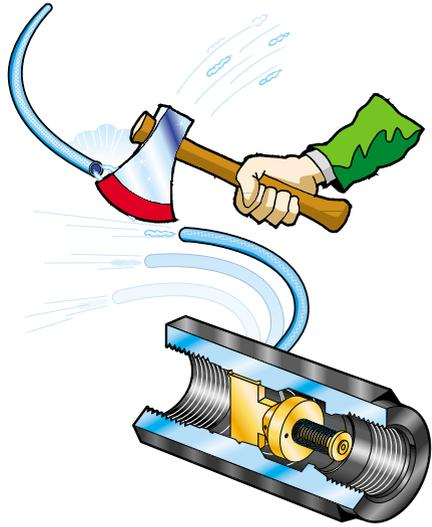
– **Protector contra escapes de manguera:** Cuando se afloja el conector de una manguera presurizada, ésta comienza a descargar aire comprimido de forma descontrolada, dando latigazos. Esto puede lesionar a las personas, dañar la pieza de trabajo y deteriorar el ambiente. Una forma de asegurar que esto no suceda es utilizar un protector contra escapes de manguera.
