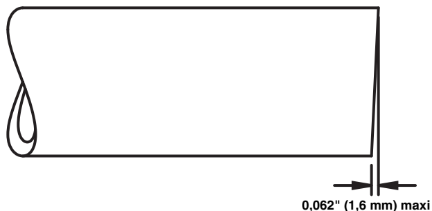
Figure 5 – Faux équerre maximal du tuyau
