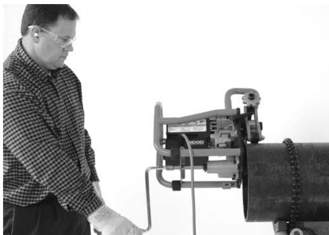
Figura 20A – Operación de biselado (pieza fija/biseladora móvil)
