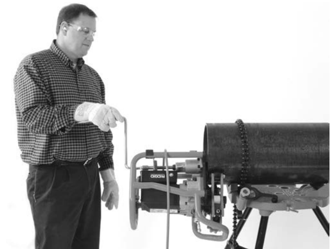
Figure 20B – Biseautage en cours (pièce fixe/machine mobile)
