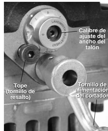
Figura 18 – Fijación del calibre de ajuste del ancho del talón
