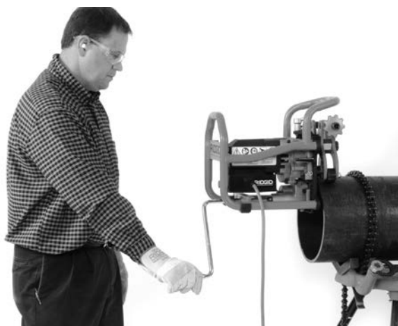
Figura 19 – Posición correcta para la operación de la biseladora
