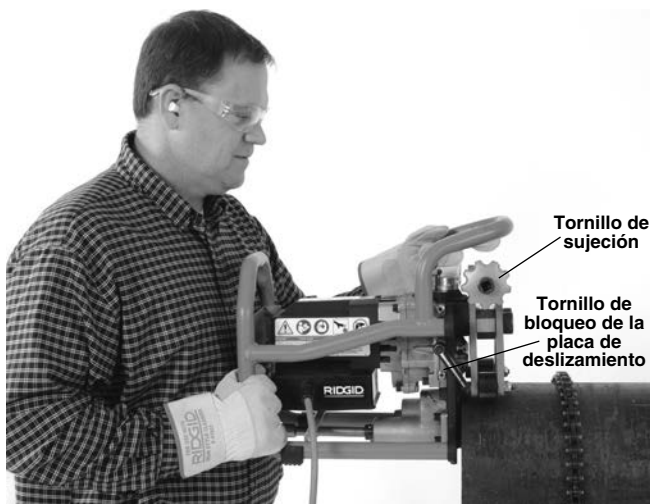
Figura 15A – Colocación de la biseladora sobre el tubo
