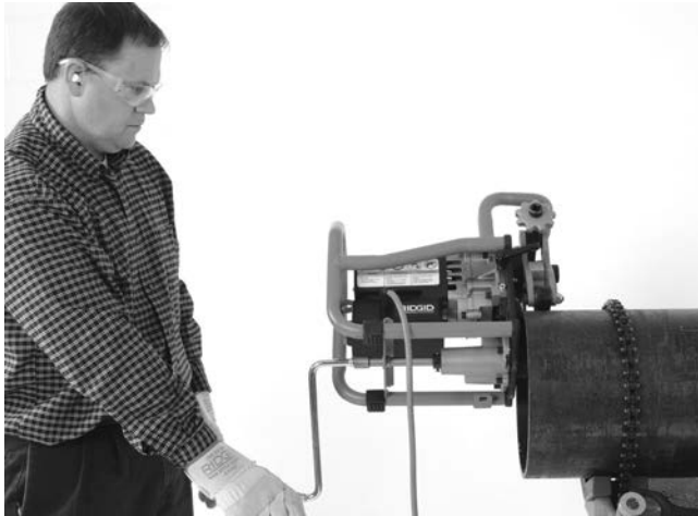
Figure 20A – Biseautage en cours (pièce fixe/machine mobile)
