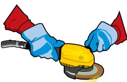
Aprietatueras angulares y amoladoras grandes llevan normalmente gatillo palanca.
