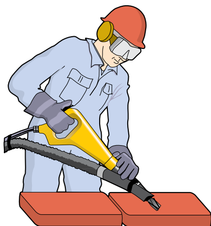
Martillo cincelador RRD con extracción de polvo, usado en la industria de la construcción.
